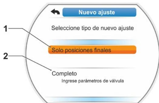
Fig. 2: Ajuste de posiciones finales con o sin parámetros
