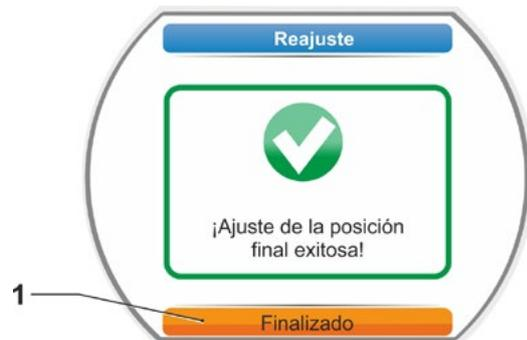
Fig. 5: Reajuste de la posición final correcta
