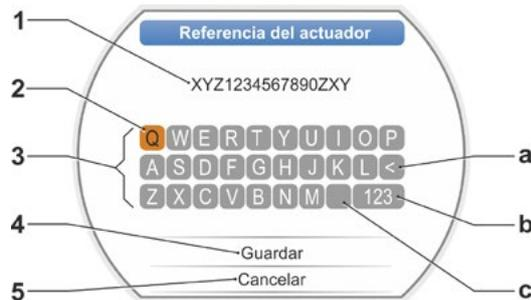
Fig. 2: Introducción de referencia del actuador
