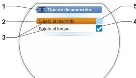
Fig.: Menú de ajuste de tipo de desconexión de posición final CERRAR
