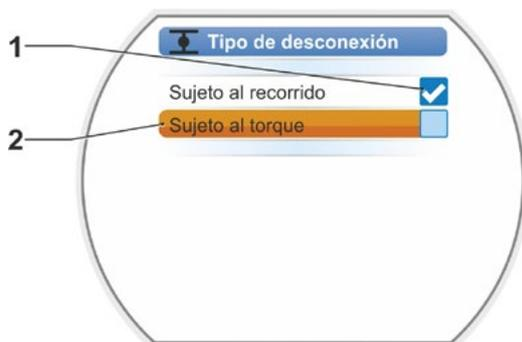
**Fig.: Ajustar menú de tipo de desconexión en posición final CERRAR**
