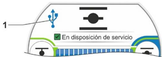
Fig. 2: Visualización en el display: Comunicación a través de USB
