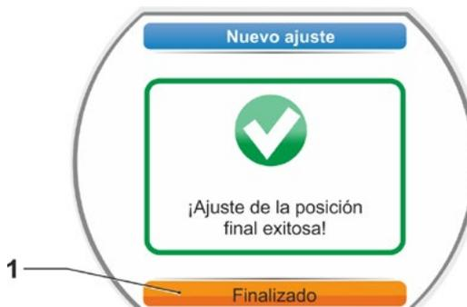
Fig. 13: Ajuste de la posición final correcto
