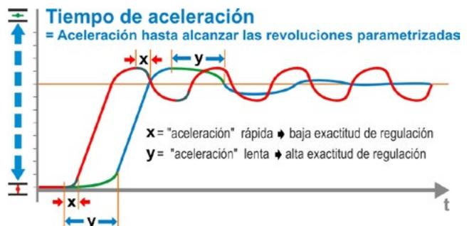
Fig.: Principio de tiempo de aceleración
