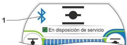
Fig.: Visualización en el display: Comunicación a través de bluetooth
