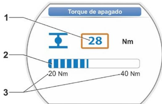
Fig.: Menú Ajustar torque de apagado
