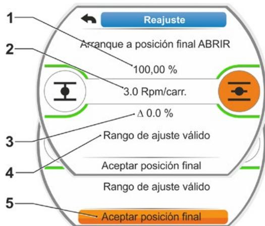
Fig. 3: Desplazar a nueva posición final y aceptar
