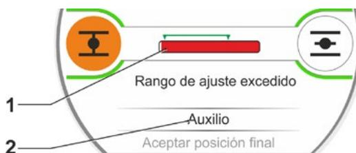
Fig. 11: Rango de posición final excedido
